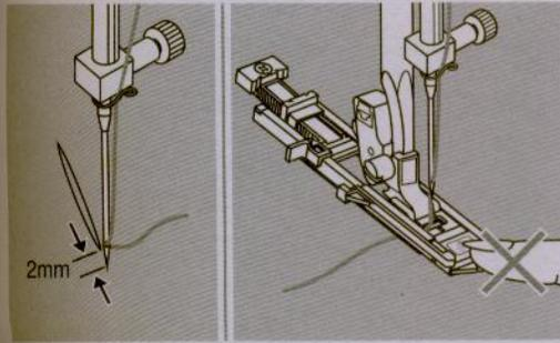
Posicione a agulha cerca de 2mm do rasgo e então abaixe o calcador.
