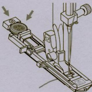
Coloque o calcador para caseados. Abra o calcador e insira o botão no local apropriado. O tamanho do caseado é determinado pelo tamanho do botão inserido no calcador. A linha deve ser passada pelo buraco do calcador e depois colocada sob o botão.
