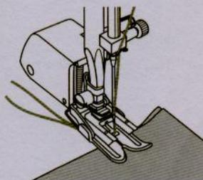
Puxe a linha da bobina para cima e coloque as duas linhas para trás do pé calçador.
