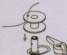
4. Passe a ponta da linha por um dos furos da bobina vazia conforme a ilustração e depois fixe a bobina no pino do enchedor.
