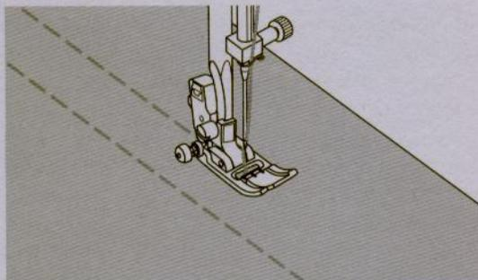
Ajuste o comprimento do ponto para 4.0mm e solte a tensão da linha de costura.
