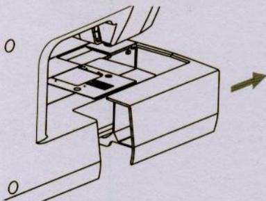
Retirando a bancada da máquina fica fácil localizar o botão de acionamento dos dentes de transporte que fica localizado na parte de trás da máquina junto ao braço livre.
