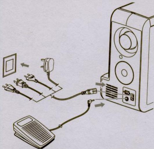
Antes de conectar a máquina na energia elétrica, tenha certeza de que a voltagem e a frequência mostrada na placa traseira da máquina está de acordo com a energia que sai da sua tomada.
