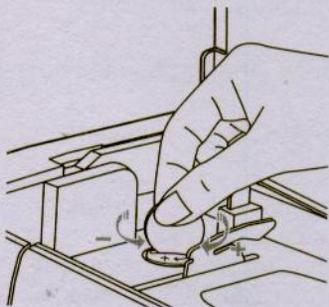
A pressão do pé calçador da máquina está pré-ajustada e necessita de ajustes especiais de acordo com o tipo de tecido que será utilizado.
