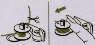
8. Após a bobina ter sido enchida com algumas voltas, pare a máquina e corte o pedaço de linha que estiver fora da bobina (veja ilustração). Depois, ligue novamente a máquina e o enchimento será completado.
