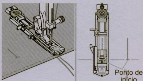
Selecione o tipo de caseado desejado. Ajuste a largura e o comprimento desejado para a densidade do caseado.
