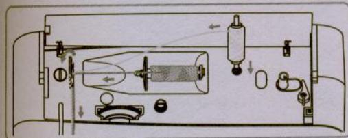
Encaixe o pino porta-retrós firmemente na máquina. Siga as instruções para alimentar a máquina utilizando o pino horizontal.
