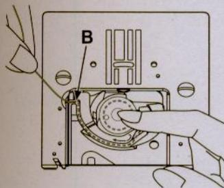
Para ter certeza que passou corretamente a linha pela mola de tensão da caixa de bobina, pressione ligeiramente com o dedo a bobina e puxe a linha. Você deverá sentir uma certa resistência para a linha sair.
