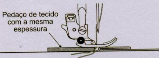
Você também pode colocar um pedaco de tecido com a mesma espessura na parte de trás do calcador. Ou então você também poderá auxiliar o calcador a transportar o tecido, girando o volante com a mão até que a máquina comece a transportar o tecido.
