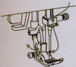
7. Pegue a ponta da linha e passe pelo furo da agulha, no sentido da frente para trás, e puxe cerca de 10 cms de linha. Utilize o cortador lateral de linha para cortar o excesso de linha.
