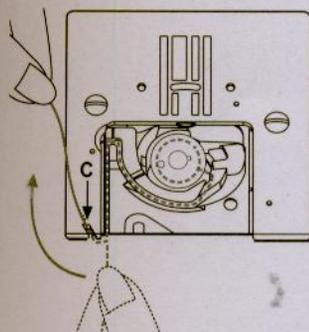
Puxe a linha na direção da seta através do guia linha da placa de agulha de B para C. Para cortar o excesso de linha, puxe para trás a linha no ponto C. Para fechar a tampa da chapa de agulha, empurre-a para trás.
