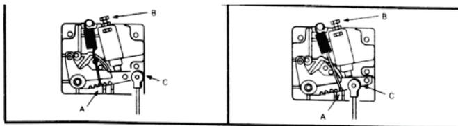
Parafuso B: Ajuste da força traseira de inclinação.
